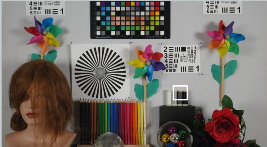
**Bildqualität im Check:** Bis einschließlich ISO 3.200 liegt die Auflösung bei der GR IIIx im Bildzentrum über der Marke von 1.800 Linienpaaren pro Bildhöhe; ein hervorragender Wert. Der Abfall zum Rand beträgt dabei rund 200 Linienpaare; ebenfalls sehr gut. Lästiges Rauschen hat die Kompaktkamera gut im Griff; Störpixel treten ab ISO 800 in Erscheinung, beeinträchtigen den Bildeindruck aber erst ab ISO 1.600 wirklich maßgeblich.
