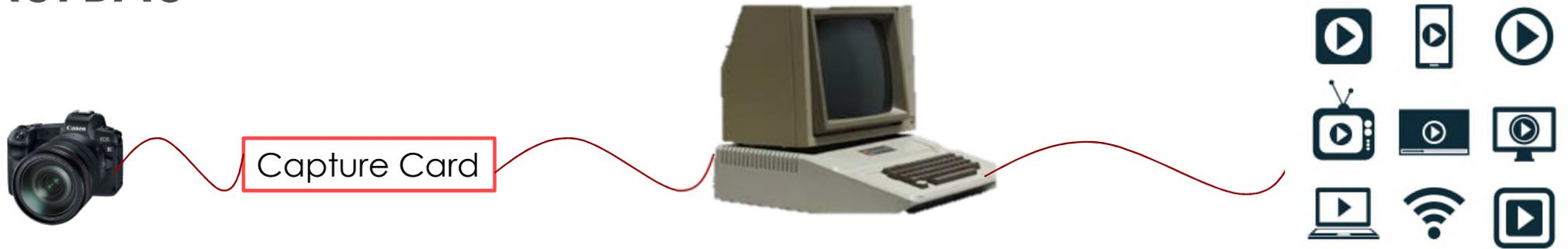
Da der HDMI eines Computers in der Regel nur ein Ausgang ist benötigt man eine Capture Card mit der das Videosignal von HDMI auf ein USB Signal umgesetzt wird.
